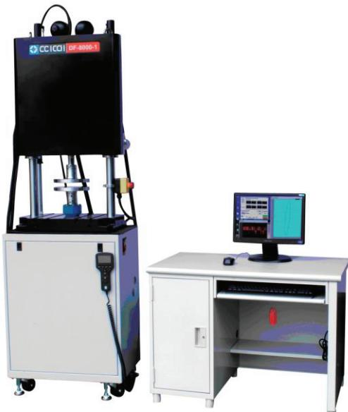
Metal, plastik, kauçuk ve kompozit gibi malzemelerin dayanıklılığının belirlenmesinde kullanılır.
